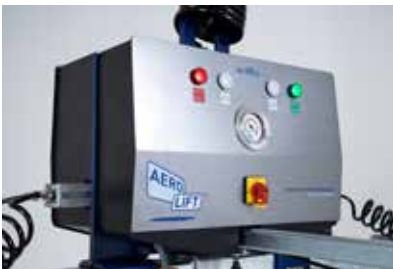
Alu-brushed Optik: Hochwertes Kunststoffgehäuse schützt Elektronik und Pumpen
