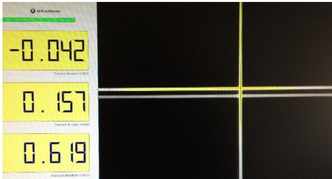
Abb. 1: Keil-Winkelmessung in Reflexion über Doppelkreuz; gemessener Keilwinkel ist 0,619 wmin = 37,14 wsec.
