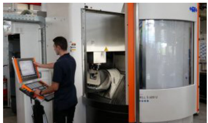
Die Mikron MILL S 600 U fräst - im Verbund einer Automationszelle - Werkstücke aus gehärtetem Stahl und Elektroden - rund um die Uhr.
