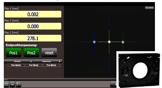
Bild: Fluchtungsmessung bzw. 3 DoF-Monitoring
