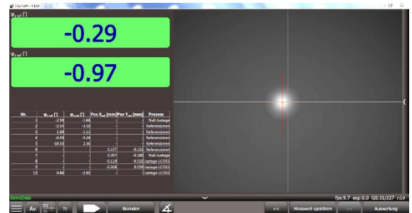
Bild: Winkelmessung mit Planspiegel + Toleranzkreis
