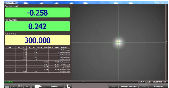
Bild: Positionsmessung mit Tripelreflektor oder Linse
